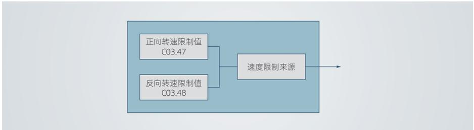
电机不同方向旋转时，转速限制仅由内部参数 C03.47 和 C03.48 决定。
