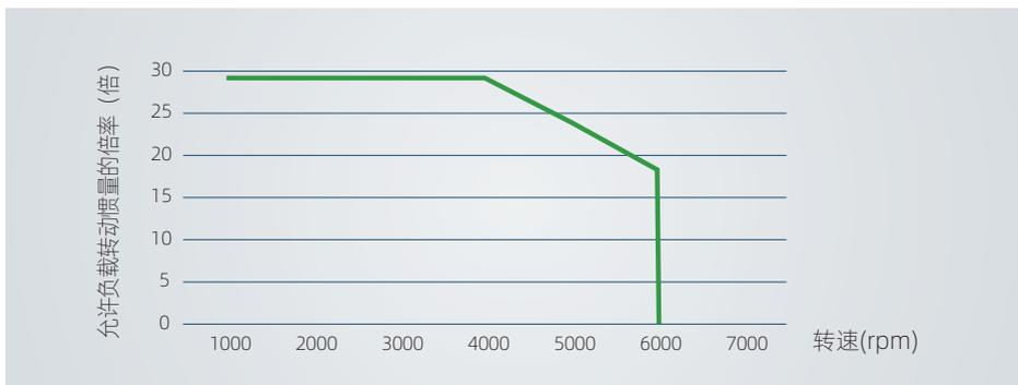
图 10-5 转速对应允许负载转动惯量的倍率
