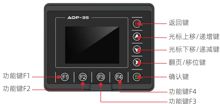
图 4-1 液晶面板示意图
