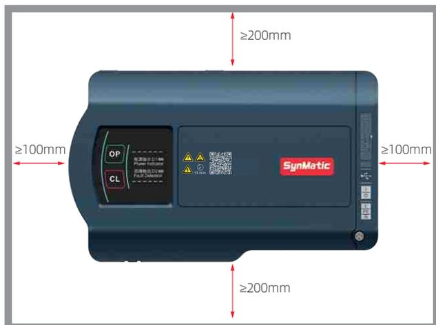
图 2-1 安装空间示意图 (单位: mm)
