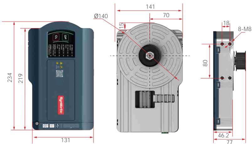
图 2-4 安装尺寸示意图 (单位: mm)
